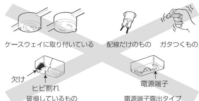
必ず取り付け可能な引掛シーリングに交換してください。交換には電気工事士の資格が必要です。交換工事は必ず電気工事店に依頼してください。
