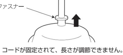
②コードの長さを調節したらコードファスナーを引き上げてコードを固定させてください。
